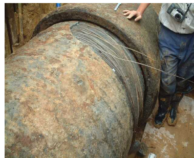
老朽化したPC管の破損状況(左:カバーコートモルタルの剥離・PC鋼線の破断、右:管体破裂状況)
