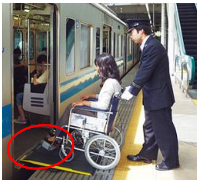
【渡り板の使用】 (出典:小田急HP)
