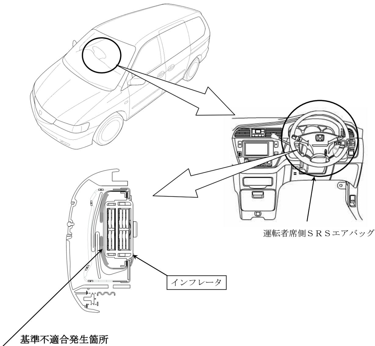
特定の運転者席側SRSエアバッグのインフレーター（膨張装置）において、エアバッグ展開時にインフレーター内圧で容器が破損して構成部品が飛散し、乗員が負傷するおそれがある。
