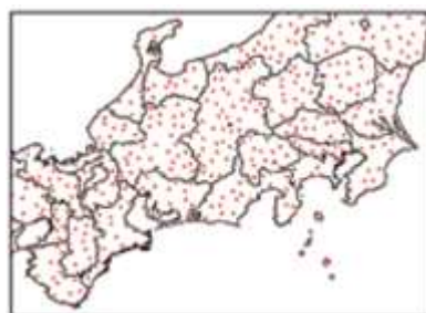
雨量計 アメダスや自治体等の観測地 点(全国で約10,000)で正確 な雨量を観測(図はアメダス 観測地点)
