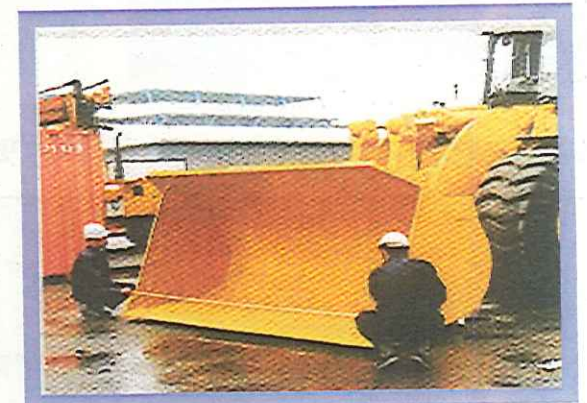
【検量】 重機の容積を計算している様子
