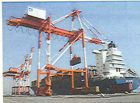
②ガントリークレーンによるコンテナ荷役（船内荷役）
