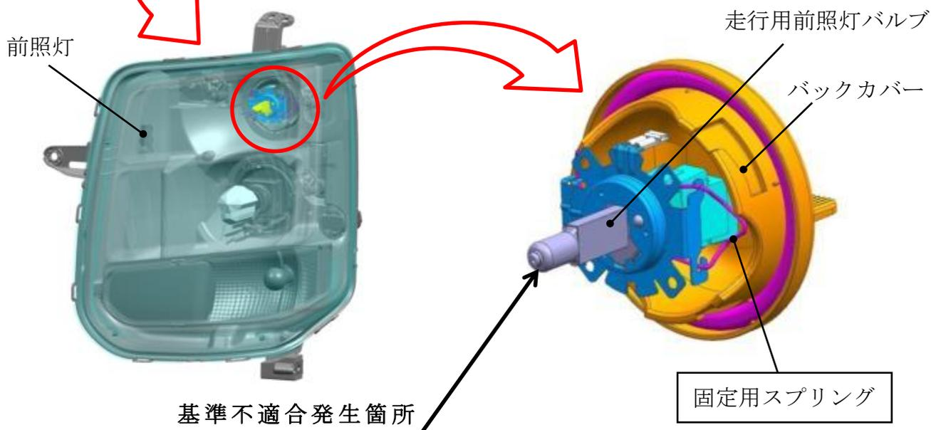
走行用前照灯において、バルブの固定用スプリングの形状が不適切なため、走行用前照灯の製造時に当該スプリングがバックカバーに干渉する。そのため、バルブが正常に固定されず、走行用前照灯の照射方向が、保安基準第32条に適合しないおそれがある。
