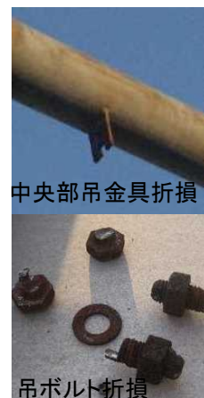
吊り下げ式標識の吊金具折損により標示板が落下した事例 ＜H25.11.20 滋賀県長浜市で発生した事案＞
