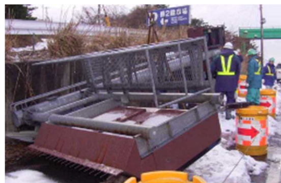
疲労き裂の影響も疑われる倒壊事例 ＜国土技術政策総合研究所資料より転載＞
