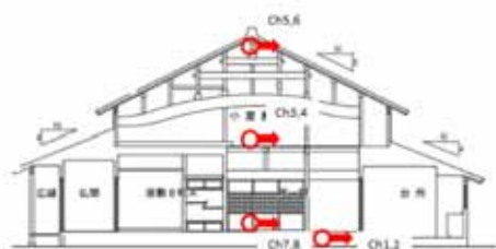
【図 64：センサーの配置 CASE2】
