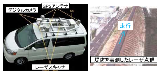
堤防の変状調査技術の例
