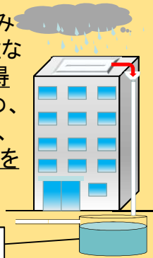
雨水貯留施設
