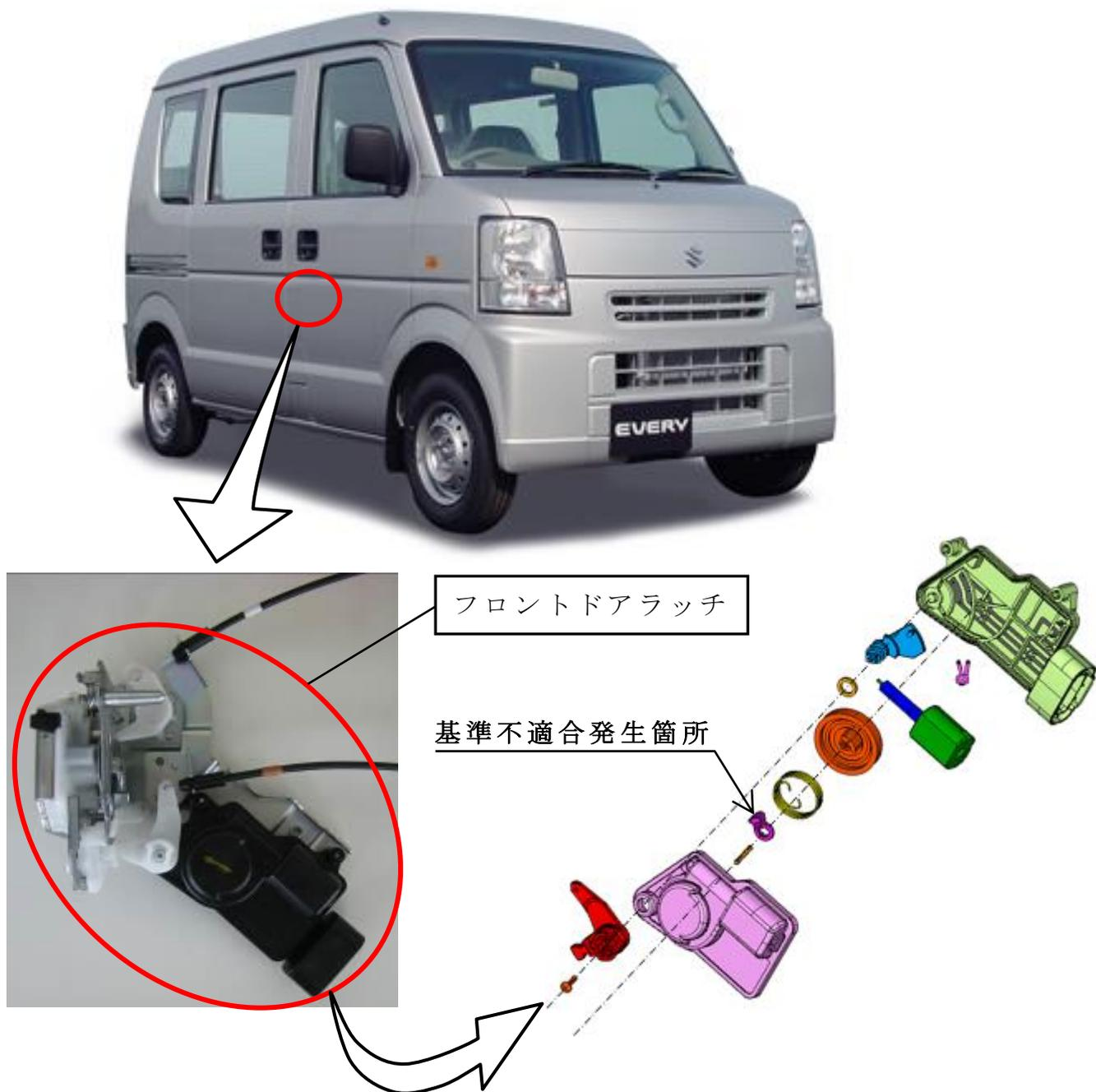
フロントドアラッチ及びバックドアラッチにおいて、製造時に異なる材質の部品を使用したため、強度が不足するものがある。そのため、施錠及び開錠操作の繰り返しにより、当該部品が破損し、施錠または開錠ができなくなり、最悪の場合、ドアを開けることができなくなるおそれがある。
