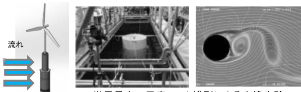
世界最大の風車マスト模型による水槽実験
