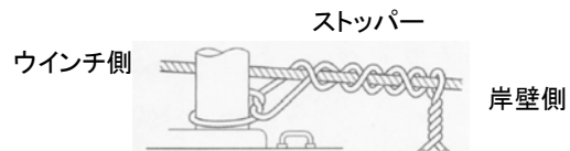
ストッパーによる索の仮止め
