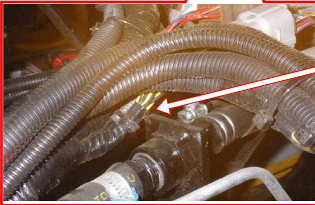
原動機制御用電気配線と、カーヒータ配管固定用ブラケットが接触
