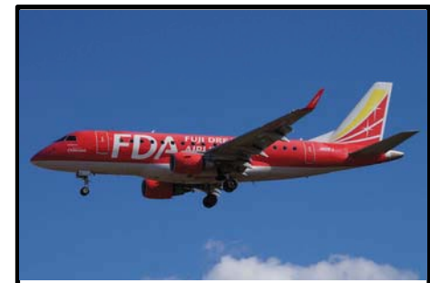
エンブラエルERJ170 座席数84席 全幅26.0m 全長31.7m 航続距離3,100km
