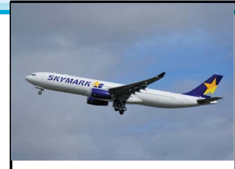
エアバスA330-300 座席数295席 全幅58.6m 全長62.6m 航続距離9,250km
