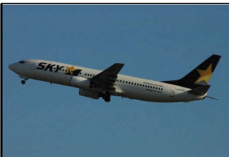
ボーイング737-800 座席数177席 全幅34.4m 全長39.5m 航続距離6,260km
