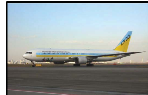
ボーイング767-300 座席数288席 全幅47.6m 全長54.9m 航続距離3,320km
