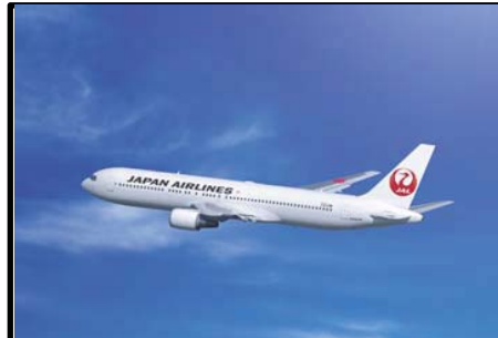
ボーイング767-300ER 座席数237席 全幅47.6m 全長54.9m 航続距離9,400km
