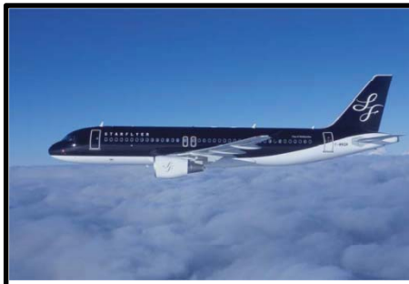
エアバスA320 座席数180席 全幅34.1m 全長37.6m 航続距離6,370km
