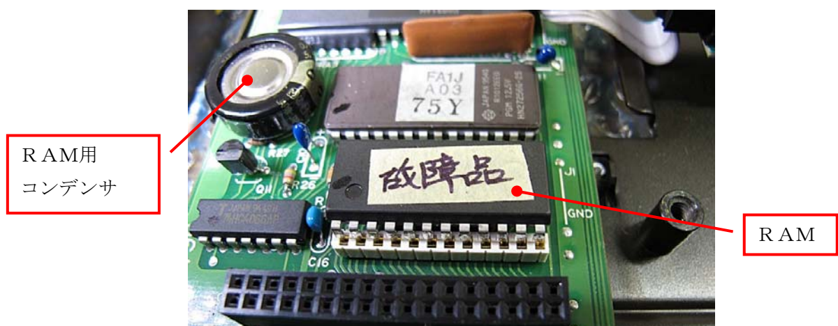
写真3 RAM用コンデンサとRAM
