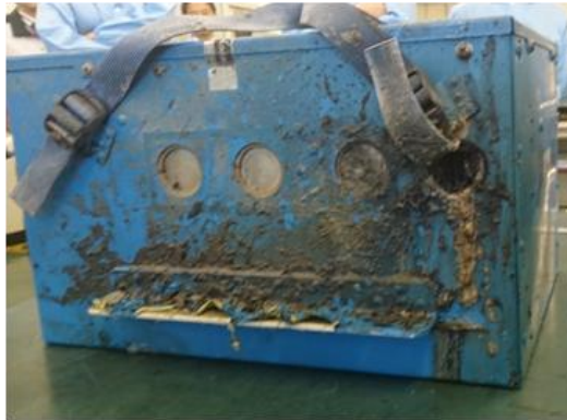
バッテリー外観（第5セルの安全弁（一番右）のみ作動）
