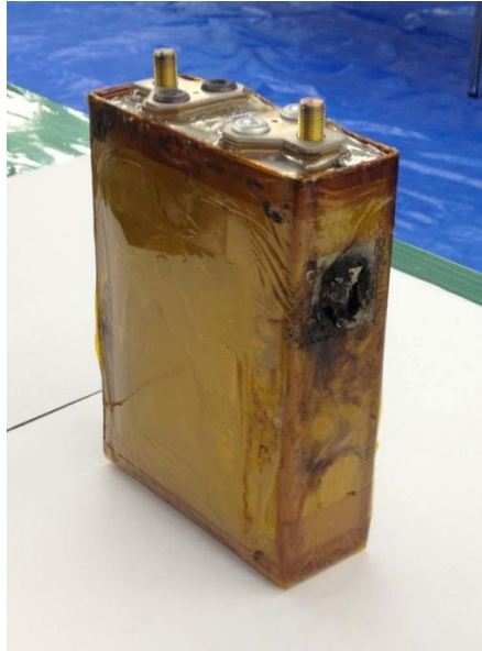
第 5 セル（安全弁が作動したセル）
