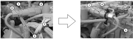
③電気配線周辺において、X点付近でリリーフバルブと電気配線とのクリアランスが十分に確保できるよう、 また、Y点付近でも②燃料チューブと電気配線とのクリアランスを十分に確保ように調整し④ストラップで固定する。
