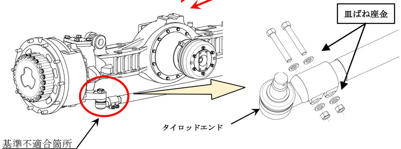
ホイール・クレーンのかじ取り装置において、タイロッドエンドのクランプボルト部の皿ばね座金に強度が不足しているものがあつたため、皿ばね座金が破損し締め付け力が低下するものがある。そのため、タイロッドエンド部のねじ部にガタが生じ、そのままの状態で使用を続けると、タイロッドエンド部のネジ山が損傷して、最悪の場合、タイロッドエンド部からタイロッドが抜けて操舵不能になるおそれがある。
