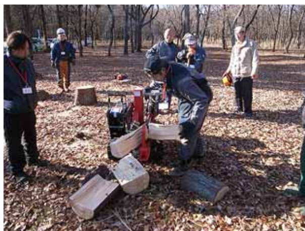
写真 5-2-20 油圧式自動薪割り機
