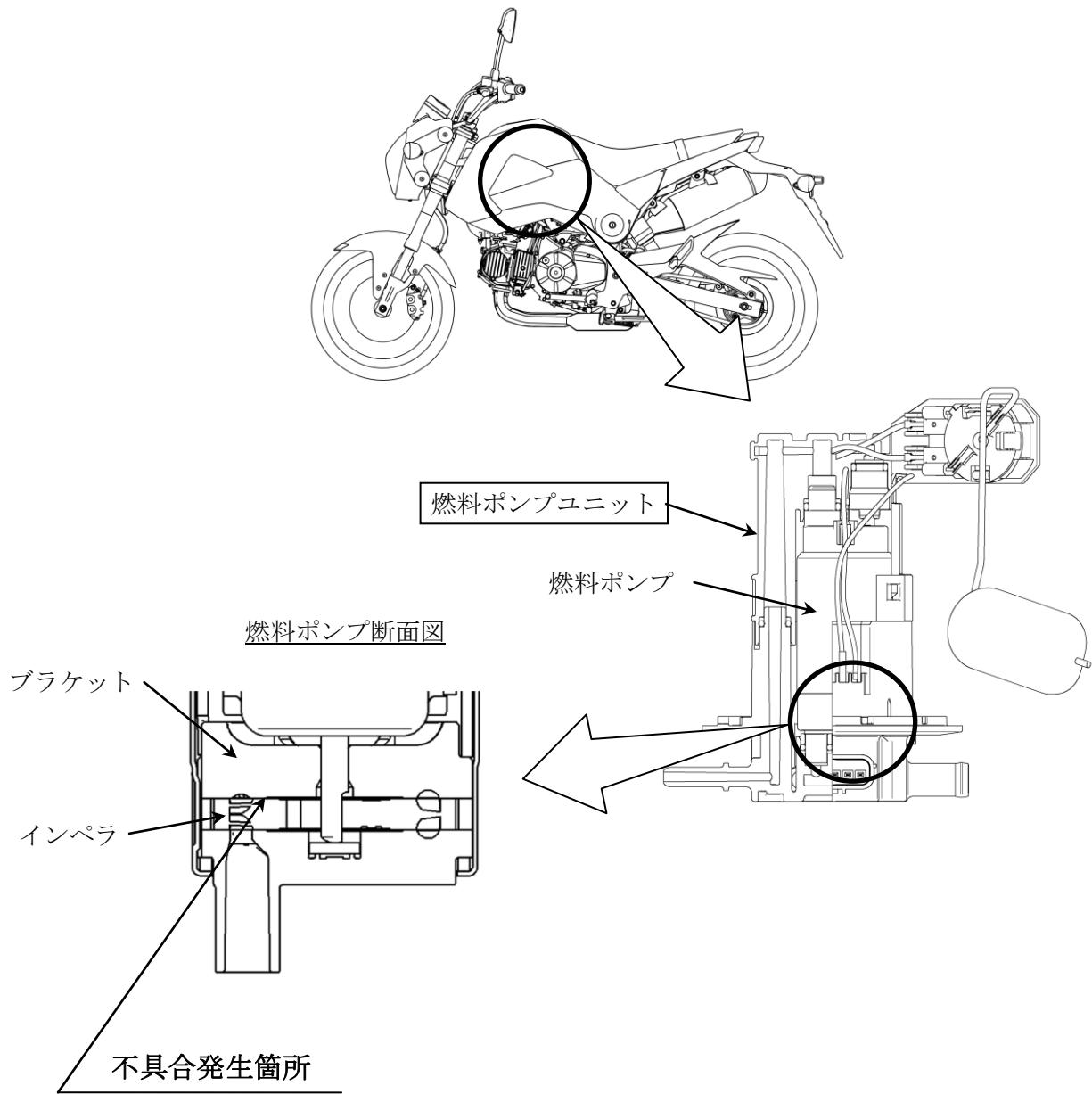
燃料ポンプ内の樹脂製ブラケットの材質が不適切なため、製造時に使用した試験油に長時間浸漬されると、使用過程において、当該ブラケットが膨張し、インペラと干渉することがある。そのため、そのまま使用を続けると、干渉部の抵抗が大きくなり、最悪の場合、干渉部から生じた磨耗粉がブラケットとインペラ間に噛み込むと、燃料ポンプが停止してエンストし、再始動できなくなるおそれがある。
