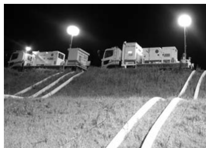
浸水エリアに排水ポンプ車を派遣し緊急排水を実施 (H25.9 台風 18 号 京都府福知山市)
