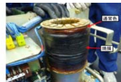
励磁コイル焼損(拡大)
