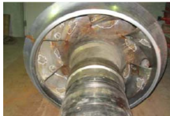
ポンプ羽根車の壊食
