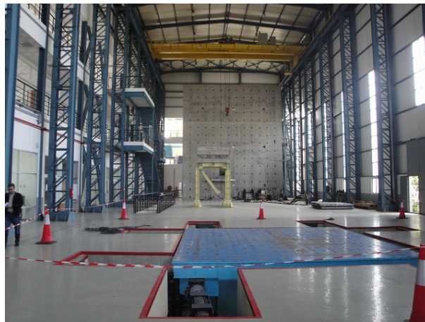
写真一 1. 5. 2. 4 アルジェリア CGS 実験施設内部（手前：3次元震動台、奥：反力壁）
