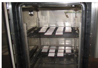
塗膜劣化促進試験の状況
