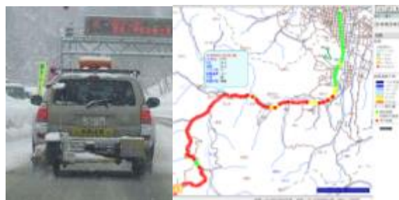
図-16.1 連続路面すべり抵抗値測定装置(CFT)およびモニタリング結果の例
