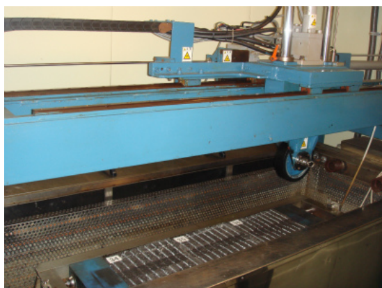
図-2.3.14 航空機荷重対応ホイールトラッキング試験機および試験後の供試体の状況
