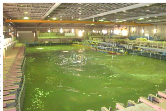
写真-2.3.3 沿岸波浪再現水槽を用いた実験風景(手前は造波装置、奥は護岸模型)
