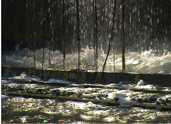
写真-2.3.2 もたれ式護岸の平面試験の様子
