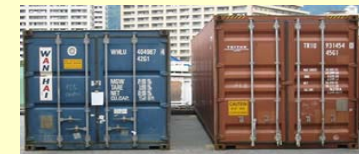
[左]40ftドライコンテナ(高さ=約2.6m) [右]40ftハイキューブコンテナ(高さ=約2.9m)
