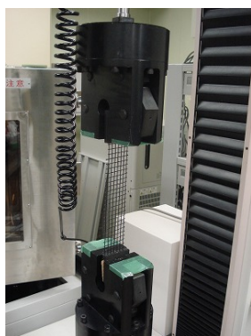
写真-2 ネット引張試験
