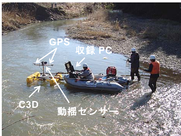
写真-1 極浅水域での C3D 計測・調査
