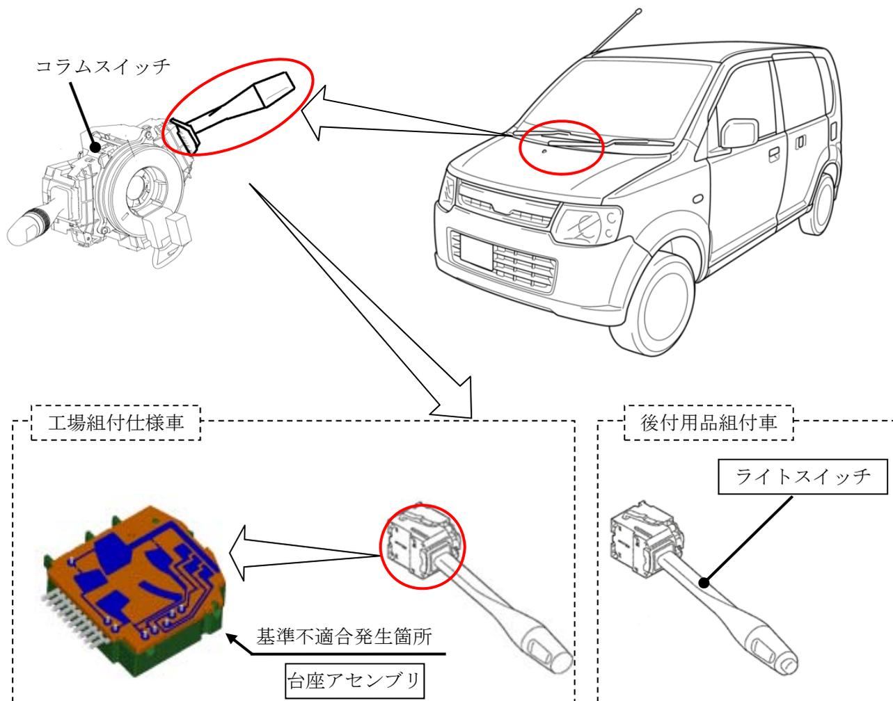
ライトスイッチの基板を固定する台座の構造が不適切なため、熱膨張・収縮の繰り返しにより、台座と基板間のはんだ部に亀裂が発生するものがある。そのため、亀裂部が一時的に導通不良となり、最悪の場合、方向指示器、前照灯等が不灯となるおそれがある。
