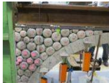
(k) 壁石の孕み状況 1
