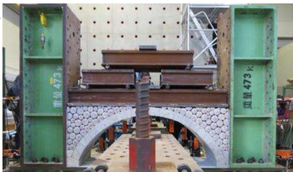
【写真3-10 実験3の石製模型と載荷装置の全景】
