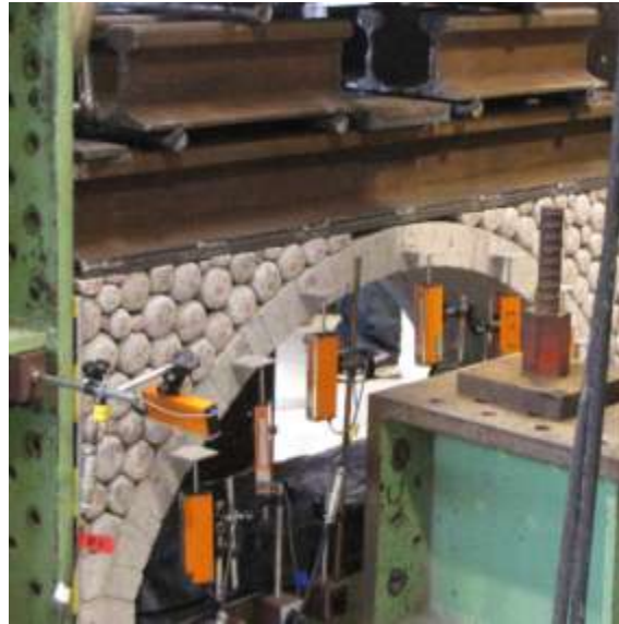
(b) アーチ輪石と壁石の変位計設置状況
