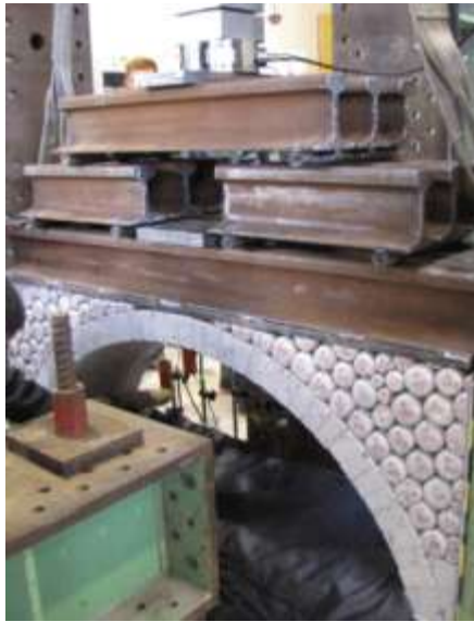
(a) アーチ模型と荷重治具状況
