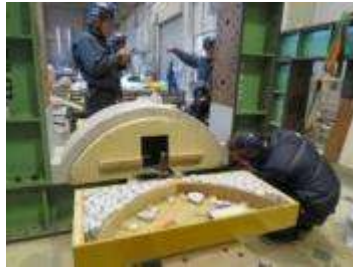
(b) アーチ輪石に壁石を積む作業
