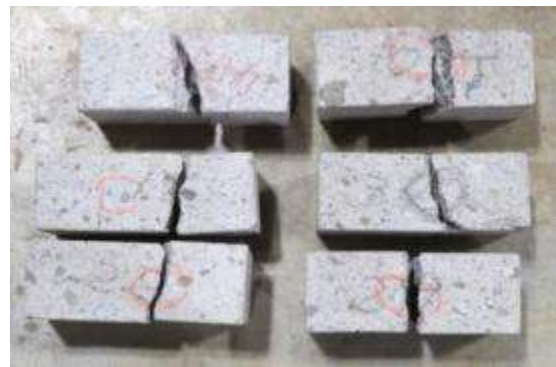
(b) アーチ輪石材のひび割れ状況例
