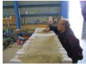
(h) 石橋内部の中詰め土砂
