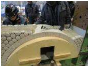
(e) 壁石と中詰土砂の状況
