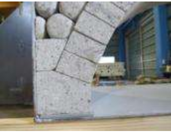
(d) アーチ支承部
