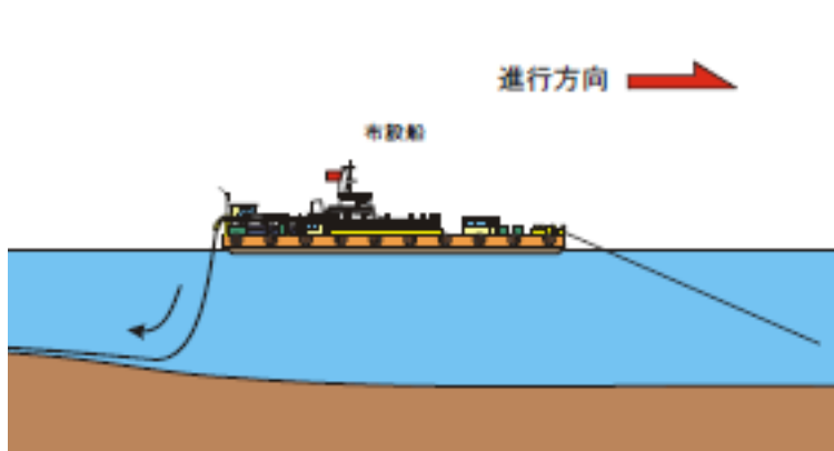
ケーブル敷設船による敷設
