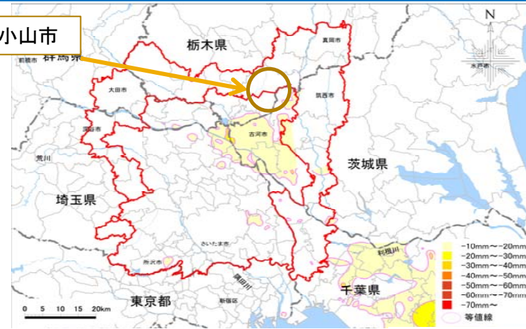
地盤沈下等量線図（平年(H14)） 小山：1,225mm/年
