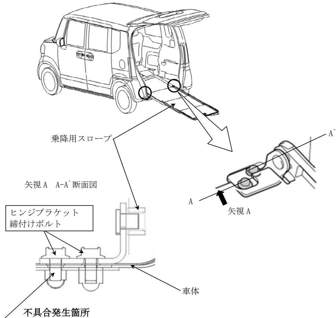
乗降用スロープ装着車において、スロープを車体に固定するヒンジブラケット締付けボルトの締付けトルクが不適切なため、使用過程で当該ボルトが緩むものがある。そのため、スロープ引き出し時または使用時に、スロープが外れるおそれがある。
