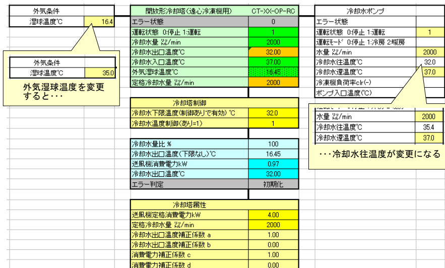
図 2.17 冷却塔のみのシミュレーション例
