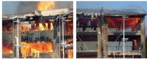
59分：枠組部分と65分：軸組部分の屋根状況
