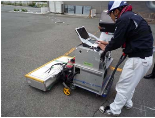
岸壁の空洞化調査（レーダー探査）
