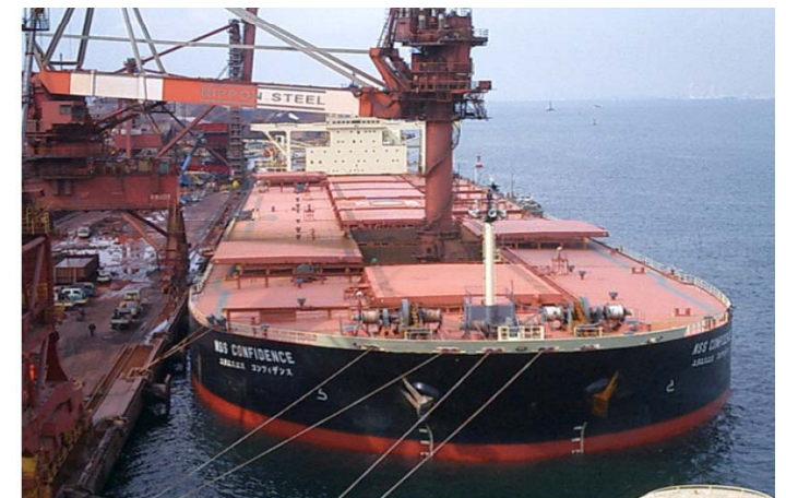
大型バルク船による鉄鉱石の荷役
