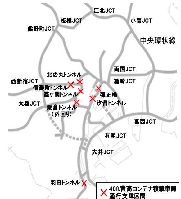
【図 首都高速道路における40ft背高コンテナ積載車両の通行支障区間】
