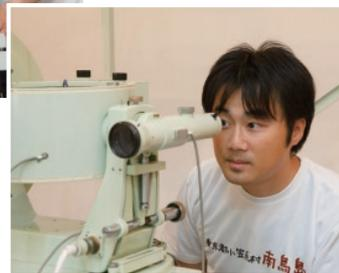
よる観測に同行。室内は、精度を保つため20度に保たれ、中央には磁気儀が設置されています。1秒間に1回の速度でハンドルを回して内部のコイルを回転させ、磁場に平行でない時に電流が流れるという原理を利用して、磁場と一致する向きを探すという仕組みで、1秒角(1度の1/3600)とごく極めて高い精度で調整しながら観測を行います。一人がこの磁気儀を操作し、もう一人が操作の補助と記録を行います。正しい磁場の向きが見つかる一瞬を狙って、「よいい、よいい」の掛け声で決まれば測定完了。この二人のタイミ
