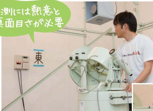
(写真上) 比較校正室で磁気儀を使った観測の様子。コイルの軸が地磁気の方角を向くよう調整する。
