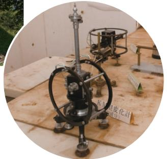
れています。地磁気観測所では精密な観測機器は、車などの磁気に影響を及ぼす人工物を避けるため、敷地奥の地下5メートルに設置。高い精度で地磁気を自動で測定・記録する一方で、人の手で行う定期的な観測によって、誤差を無くし、正確な値に補正しています。二つの測定法が補完し合い、正確で継続的な観測を実現するのです。
