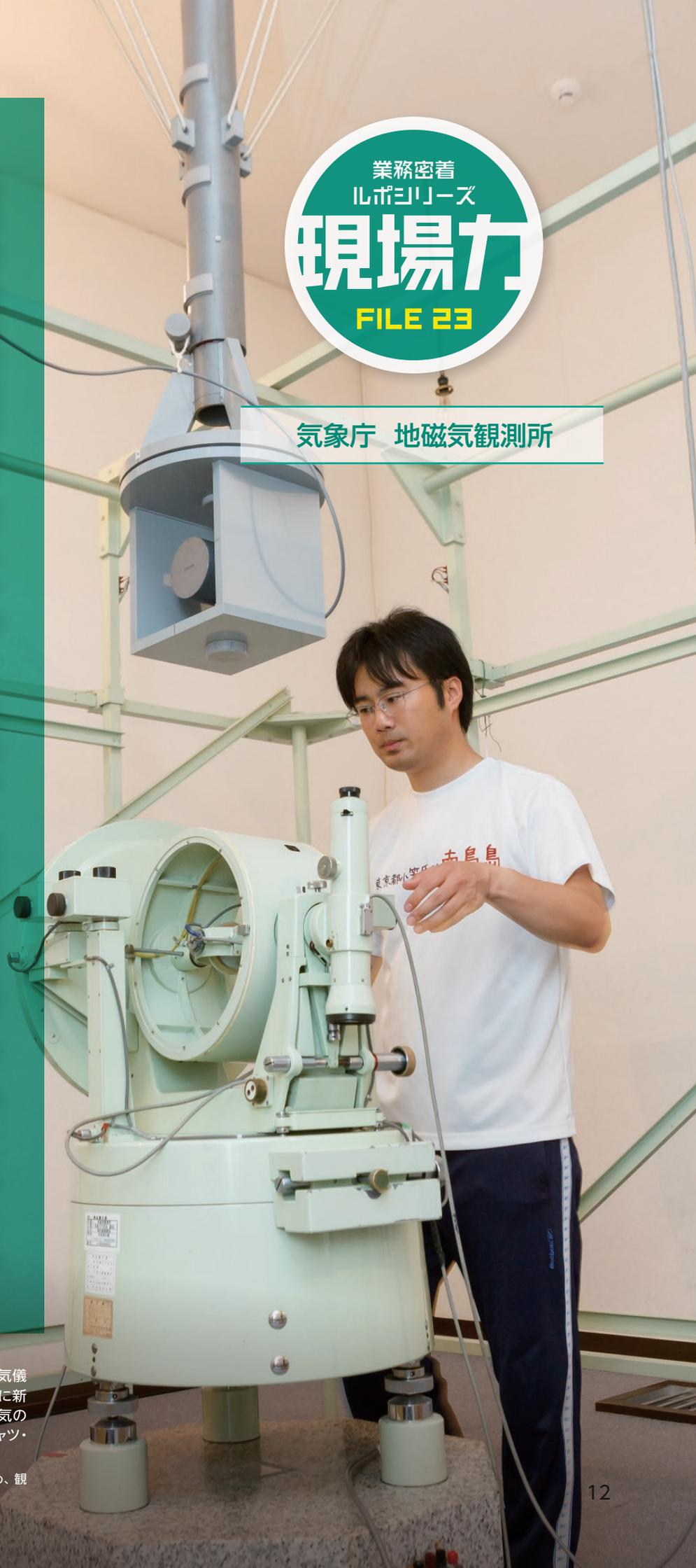
観測施設のうち比較校正室こうせいで使用している磁気儀は昭和47年製。世界に1台しかなく、どんなに新しい観測器よりも精度が高い。観測の際は磁気の影響が出ないようにファスナーなどが無い、Tシャツ・ジャージ姿で行う。
