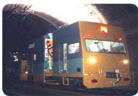
トンネル覆工撮影車による撮影の様子
