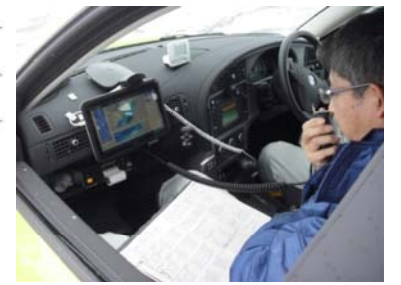
気象情報をリアルタイムで把握し、除雪指導 (タブレット端末を搭載した除雪指導車)
