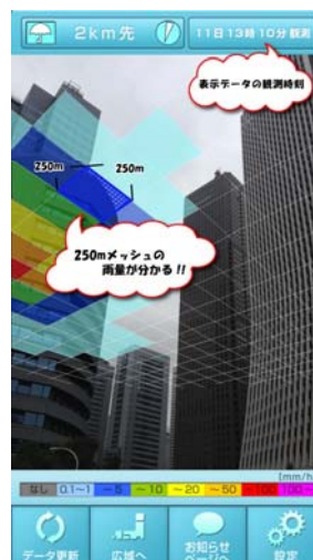
スマートフォン等のカメラを空にかざした時にはカメラを向けた方向の降雨の状況を表示
