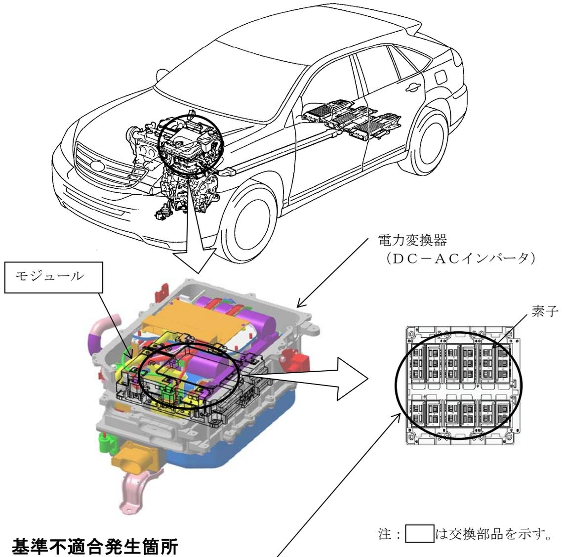
ハイブリッドシステムの電力変換器 (DC-ACインバータ) において、モータを制御する回路上または発電機を制御する回路上の素子間にばらつきがあると、素子温度が上昇して放熱用半田の許容温度を超え、放熱用半田および素子が損傷することがある。そのため、警告表示が出て走行不能となることがある。最悪の場合、高電圧系統の電流が制御系回路に流れ、電源回路のヒューズが切れて警告表示が出ることなく走行不能となるおそれがある。
