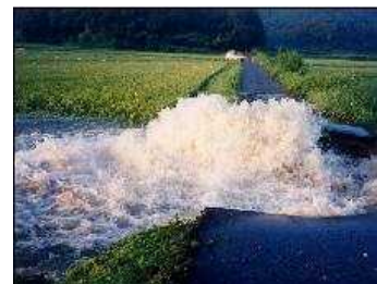
(出典) 水資源機構 HP 写真1-4-2 支線パイプラインからの出水
