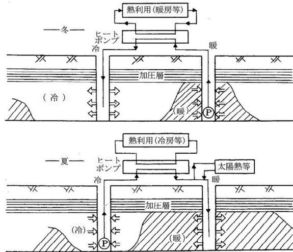
図2 地下水の熱利用システムの例
