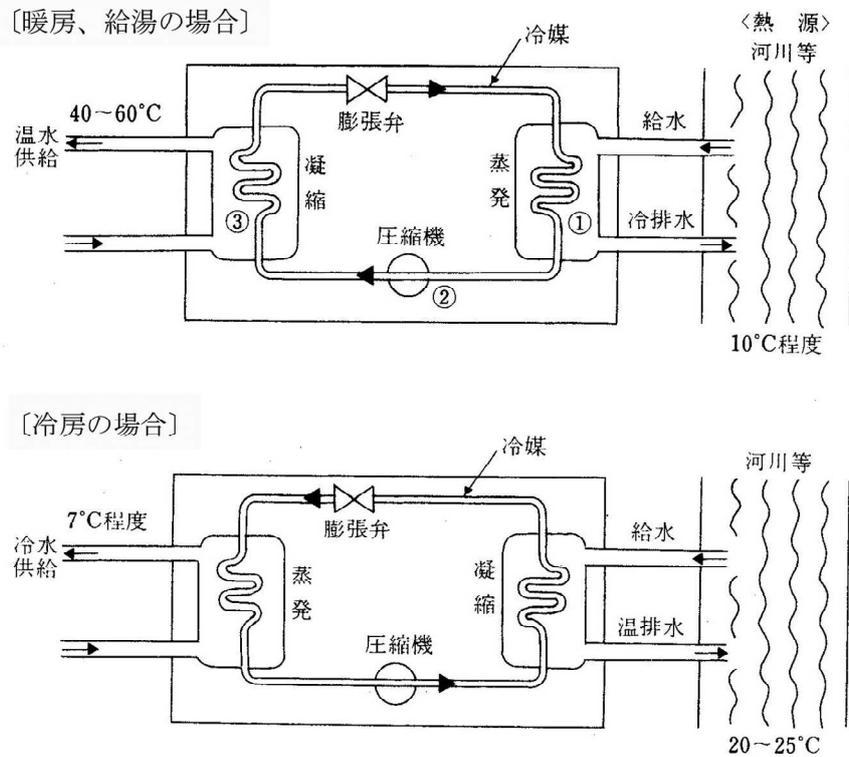
図 ヒートポンプによる熱利用の例
