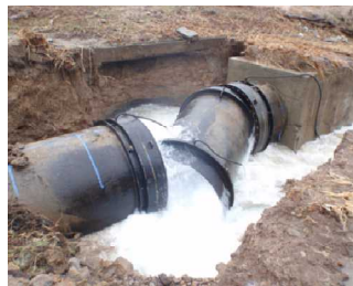
(出典) 厚生労働省資料 写真1-4-1 鋼管可とう管の離脱
