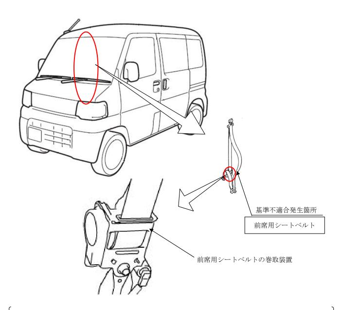
前席用シートベルトにおいて、巻取装置内部のロック機構部の製造方法が不適切なため、圧入部が緩み、シートベルト脱着時に異音や引っ掛かりが発生するおそれがある。そのまま使用を続けると、最悪の場合、圧入部品が外れ、衝突時にシートベルトのロックが作動しなくなる。
