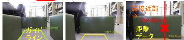
図4 距離センサ値の画像重畳によるガイド表示
