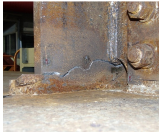
最終破壊状況（塑性率2.0の試験体）
