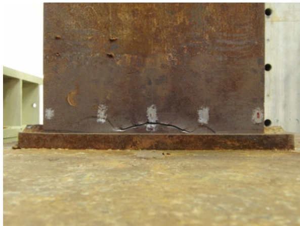
最終破壊状況（塑性率2.0の試験体）
