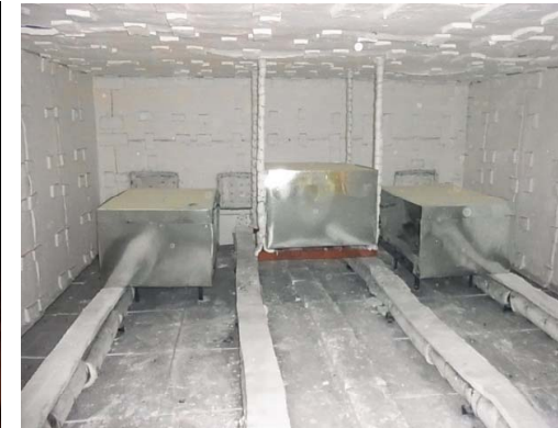
燃焼チャンバー内の ウレタンブロック(火源)
